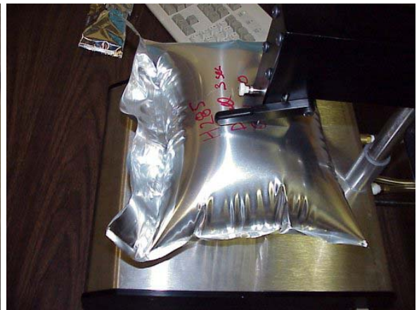
Testarea ambalajelor de tip pachete flexibile prin presurizare conform cu metodele de testare ASTM F1140 and F2054 utilizând instrumentul Creep Burst Tester
